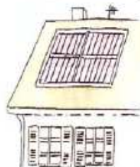
Panneaux solaires thermiques
